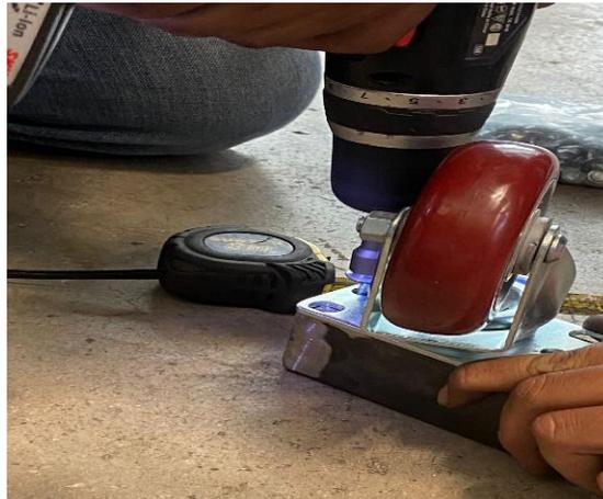
Figura 31. Instalación de ruedas.
