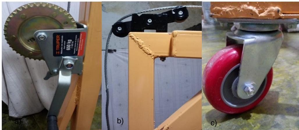
Figura 11. Detalle del malacate a), el tipo de poleas dobles b) y las ruedas c) utilizadas en el vehículo- grúa.
